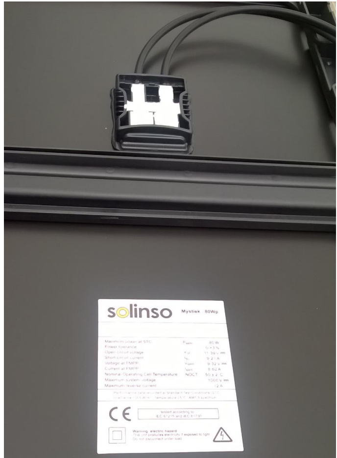
Figuur 1 Foto van de achterzijde van een Mystiek paneel waarvan de deksel van de junction-box is verwijderd. Het witte potting materiaal is duidelijk zichtbaar.
